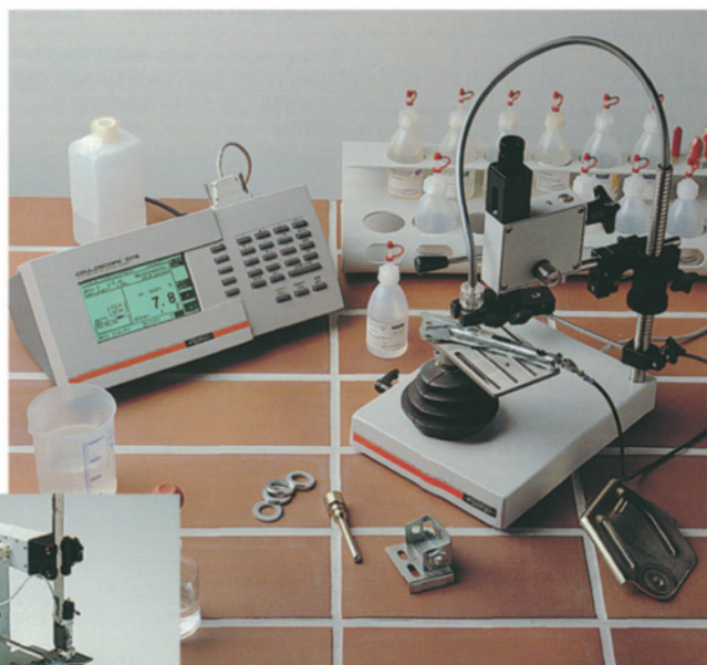
Stativo di misura V19 con alimentazione dell'elettrolita comandata dall'apposita pompa
