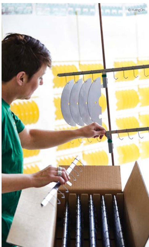
Telaio a croce con ganci da 1,5 mm di diametro su barra, pronti all'uso.
