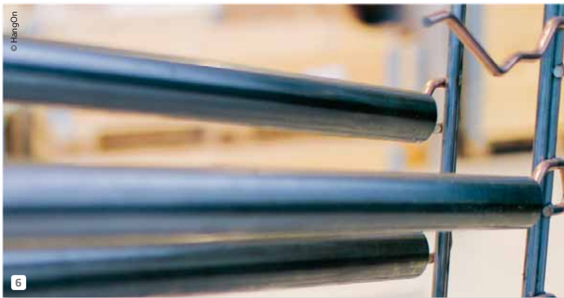
6 A frame for hanging pipes. Telaio per l'appensione di tubi.
