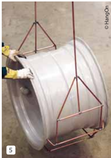
5 A frame to hang large-diameter wheels. Telaio per l'appensione di una ruota di grande diametro.
